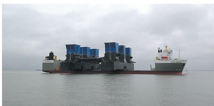
昨天6时30分,半潜船“马林”轮从南通狼山锚地起锚,载运价值高达4.1亿元的海工浮体出江,出口驶往新加坡。据了解,该海工浮体为南通吉宝船厂所造的全球新型深海半潜钻井平台的底座,总长120.48米、宽度92.22米、高度36.5米、吃水4.36米,重量15000吨。航行时,“马林”轮航迹带宽度223米。
