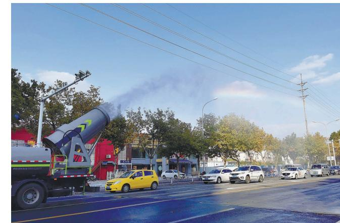
23日下午,崇川区环卫处一辆雾炮抑尘车行进在市区主干道进行路面喷雾作业,遏制扬尘污染,改善城市空气质量。雾炮抑尘车作业时,弧形水雾下方瞬间形成一道美丽的彩虹。
