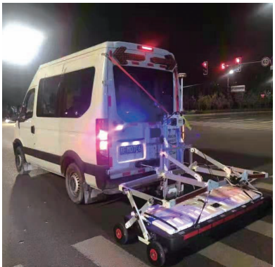
雷达车对道路进行地毯式“扫描”,及早发现并消除路面塌陷隐患。任恬
