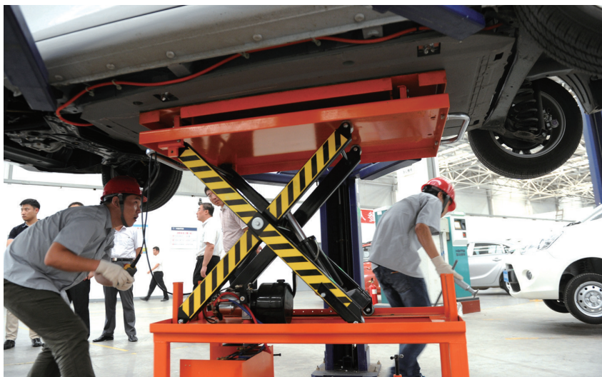
海马换电式电动轿车换电演示。 CFP供图
