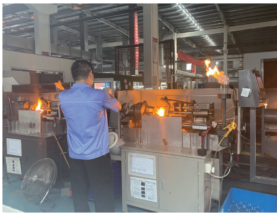
工人轻点屏幕即可完成玻璃杯的封口操作。
