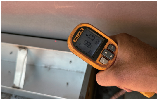
施工人员测量止裂钢预热温度。
