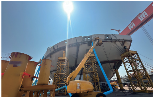
烈日下装配,冷风机管道通向高架车。
