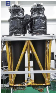
▲“风行天”空间X射线望远镜 ▼爱因斯坦探针卫星“风行天”X射线望远镜所拍摄的月球X射线图像
