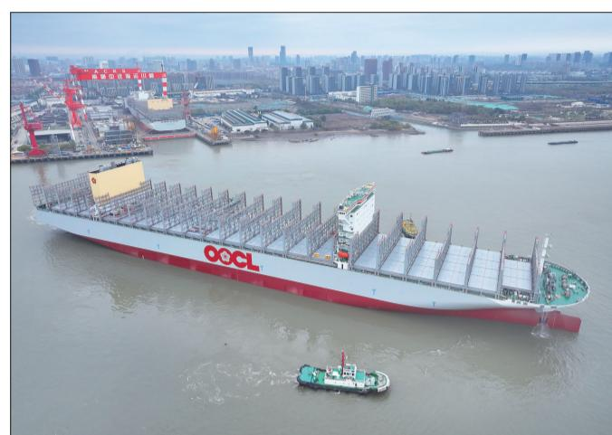
昨天,在南通中远海运川崎码头,一艘最大级别集装箱船出海试航。这艘船总长约367米,型宽51米,总高约67.5米,最大载重量达16.5万吨。该船融合了最新技术成果与智能化手段,在智能化管理系统、节能环保等多个方面有着独特优势。这是南通中远海运川崎完全自主研发、设计建造的又一力作。
