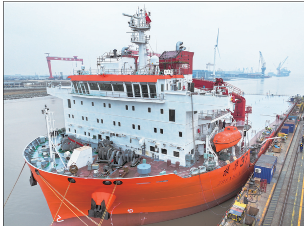
5日在启东海工船舶工业园拍摄的上海振华重工自主设计和建造的首艘30000吨级重大件甲板运输船“振华37”轮。
