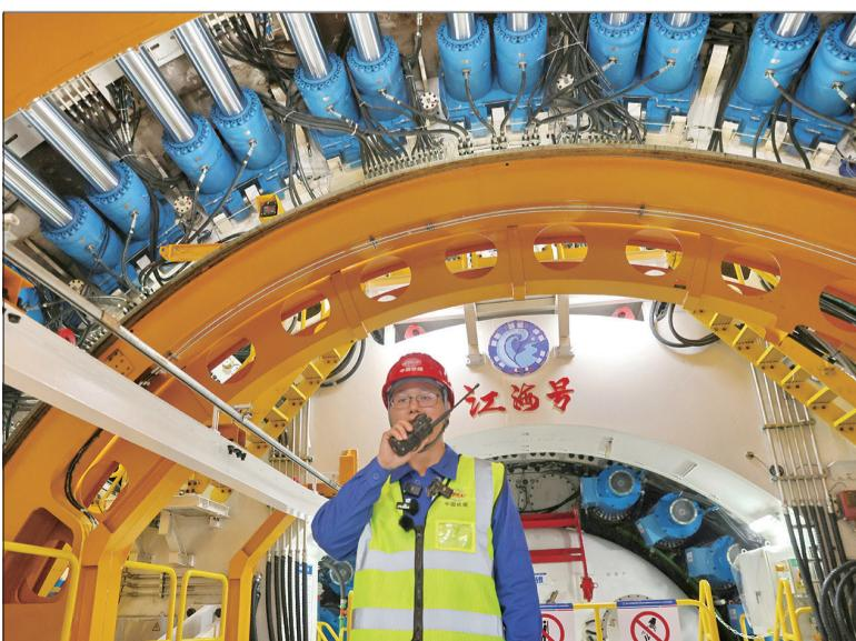
昨天上午,在位于长江入海口的南通海门,随着巨大的刀盘开始轰鸣转动,我国自主研制、开挖直径达16.64米的“江海号”盾构机顺利始发,标志着世界上最长公路水下盾构隧道——海太长江隧道开启穿越长江之旅。记者朱蓓宁 彭军君 许丛军
