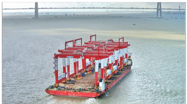
昨天,“厚德198”轮装载着广州南沙5台双悬臂自动化轨道吊缓缓驶离振华南通分公司码头,前往南沙四期全自动化码头。该项目吊具下额定负载41吨,跨距31米,起升高度18.1米。这批设备的投入使用将大幅提升南沙四期全自动化码头的集装箱吞吐能力,增强南沙港在区域港口竞争中的优势。
