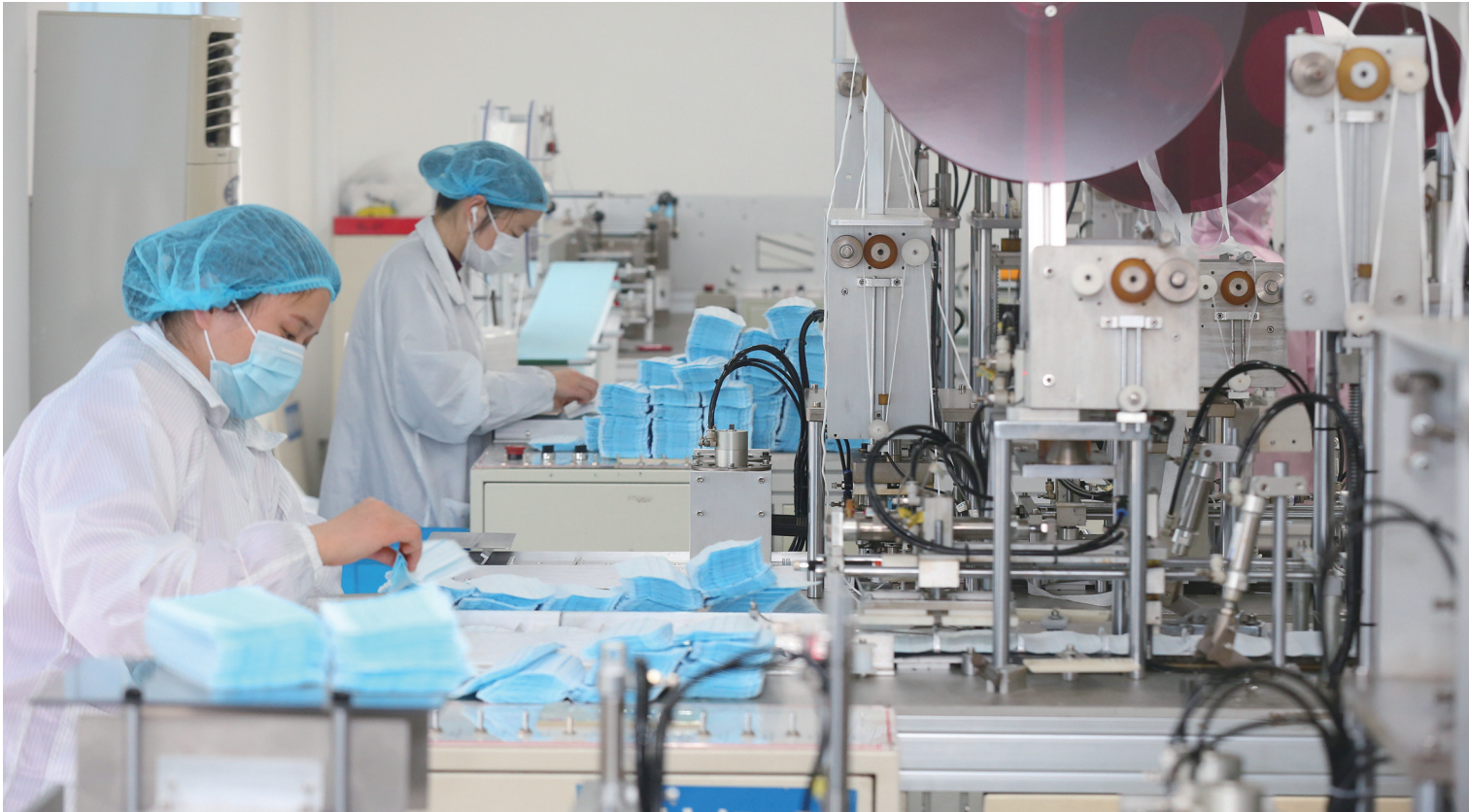
位于南通综保区A区的千野实业专业从事各类口罩的生产,口罩产品原本100%出口,为了保证疫情防控的需要,企业已暂停出口,生产线开足马力。据了解,节后复工以来,在综保区管理局的支持下,企业日产口罩25万只,满足政府物资调拨,助力国内疫情防控。图为昨天拍摄的企业车间的生产画面。
