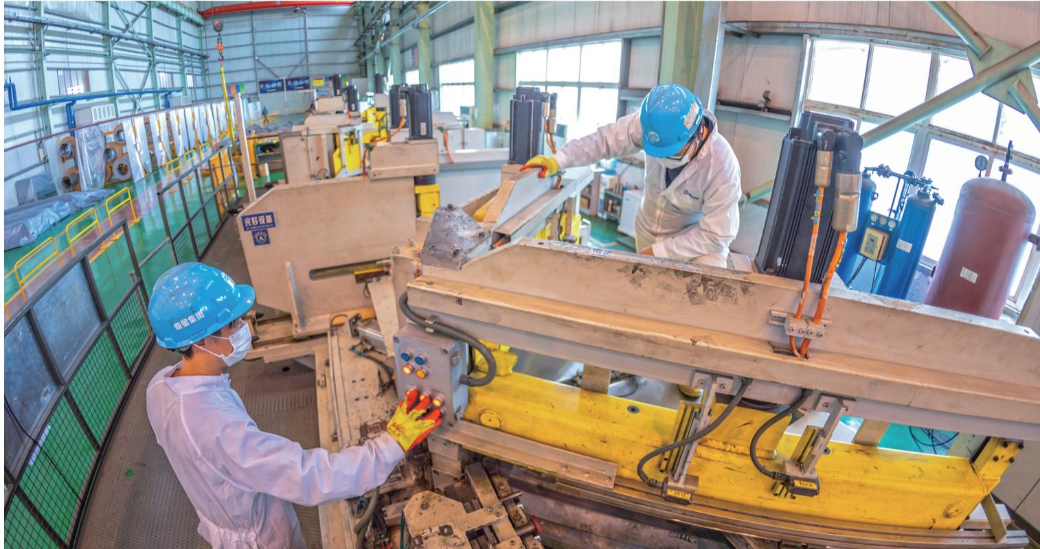
22日,海安市经济技术开发区晓星变压器车间内,工人对即将出口的变压器进行组装、检测。
