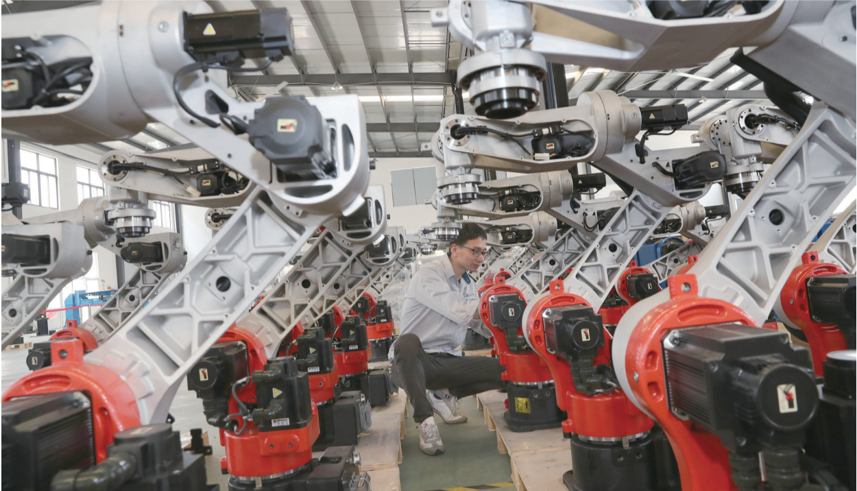
24日,位于海门市正余镇的南通振康机械有限公司的技术人员在机器人待测区调节皮带张力。机器人产业是正余镇的特色产业,为缓解疫情带来的影响,正余镇引导机器人生产企业与“用工荒”企业对接,进行自主化装备改造提升,成功研发建筑装备机器人、烟尘处理环保机器人、焊接机器人等,为多家企业解决了用工困扰。
