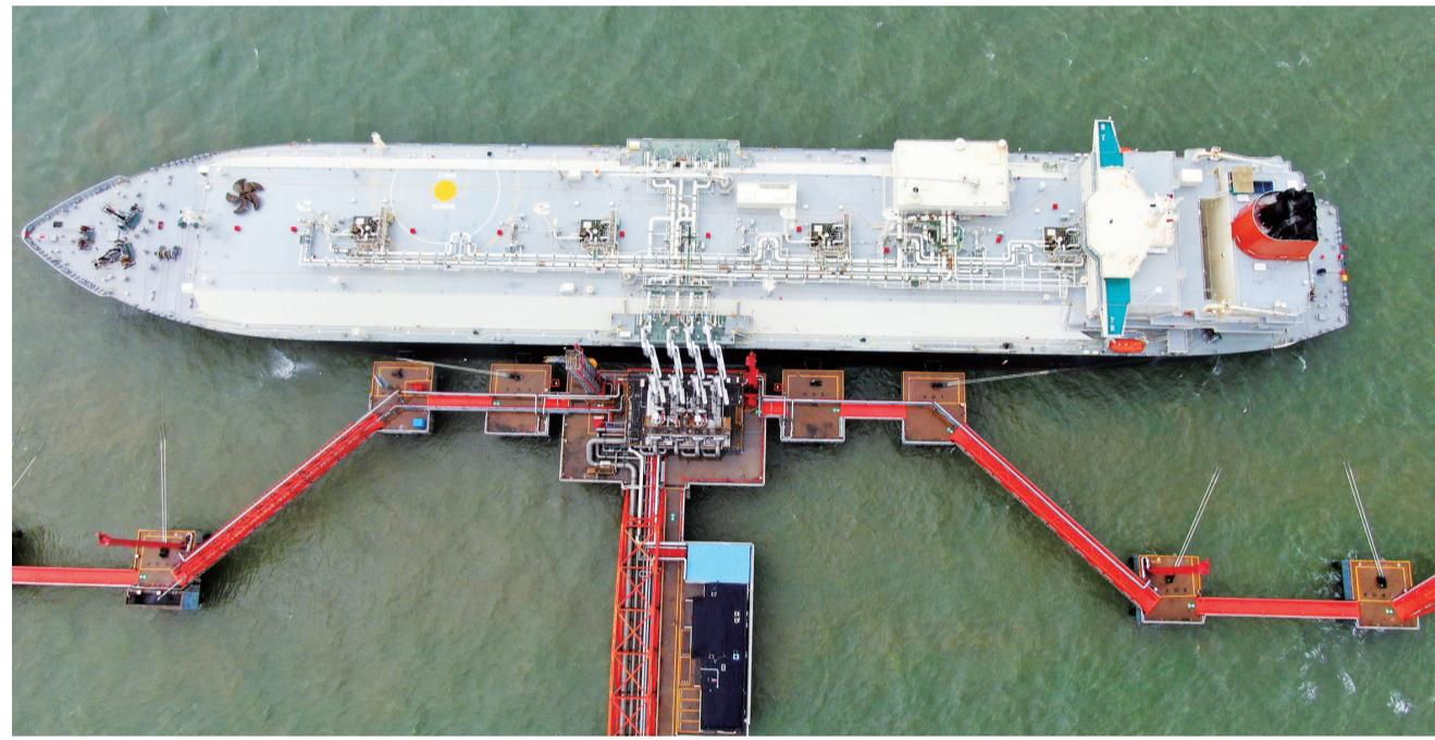
本报讯 (记者吴暇 徐书影)23日,洋口港阳光岛LNG码头,来自巴布亚新几内亚的天然气从“海拉精神”号LNG船上,通过卸料臂源源不断地输入中石油江苏LNG接收站管道,然后进入储气大罐(上图 记者许丛军摄)。至此,今年以来,洋口港累计接卸32船总量达268万吨,外输天然气36.5亿立方米,在疫情防控阻击战中有效保障长三角绿色能源供应。
