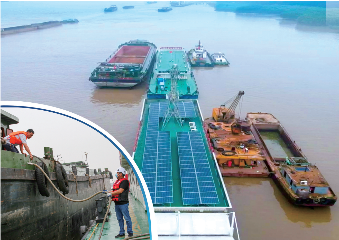
昨天，在位于如皋市长江镇的如皋水上绿色综合服务区，船舶在工作人员的配合下通过“北斗船舶生活污水接收装置”免费处理生活污水。据了解，该服务区在全省率先引进了北斗船舶生活污水接收装置，实现全过程闭环监测和环保大数据监控，有效避免港内作业船舶污水偷排、漏排。CFP供图
