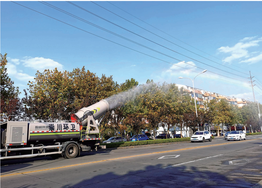
昨天下午，崇川区环卫处一辆雾炮抑尘车行进在市区主干道进行路面喷雾作业，遏制扬尘污染，改善城市空气质量。雾炮抑尘车作业时，弧形水雾下方瞬间形成一道美丽的彩虹。
