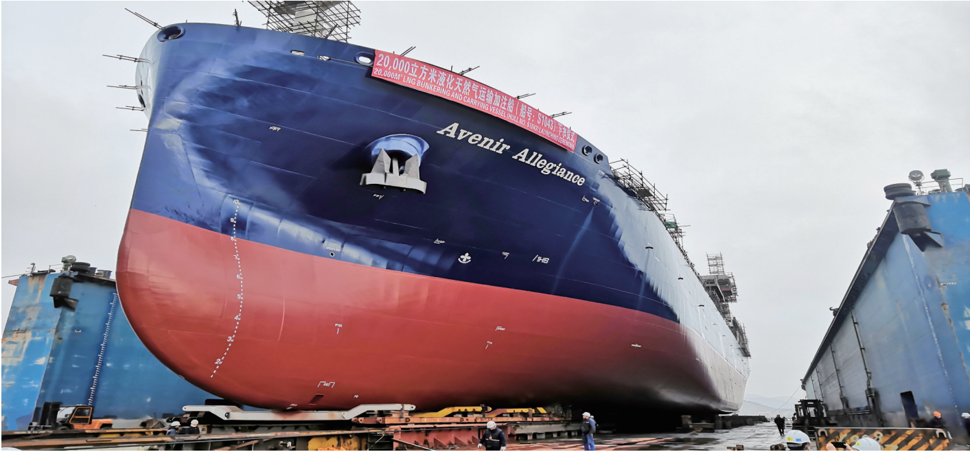
27日,南通中集太平洋海洋工程有限公司为Avenir LNG 公司建造的全球最大20000m³LNG运输加注船在舟山长宏国际船舶修造有限公司顺利下水。该船总长159.9米,型宽24米,型深16.75米,设计吃水8米,为目前世界上最大的LNG 燃料加注船。该船由中集太平洋海工自主设计建造,具有安全、节能和环保等特点,在兼顾LNG运输功能的同时又能为其他船舶及终端加注LNG。 黄海文 吴晓明摄
