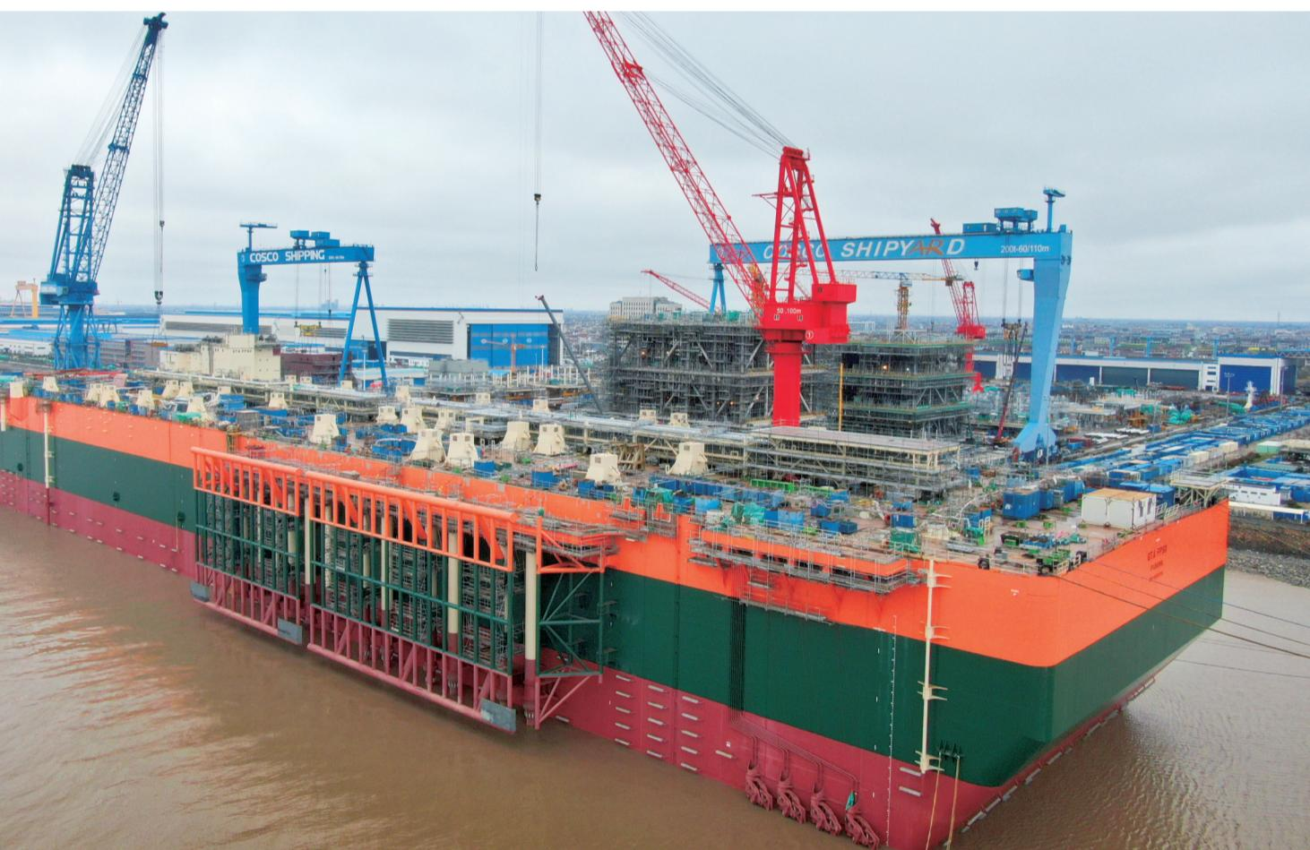
昨天,记者在中远启东海工码头拍摄的浮式生产储油船。3月19日,由启东中远海运海洋工程有限公司承建的FPSO(浮式生产储油船)顺利出坞,将进行生活区等设施的建造与安装。据了解,该轮船长270米,型宽54米,型深31米,是中国船企首次为非洲项目建造的浮式生产储油船。该船交付后将赴西非毛里塔尼亚和塞内加尔海上油田服役。
