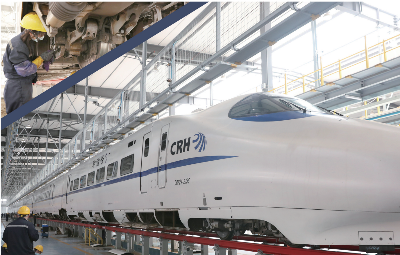
6日,在南通动车运用所检修库内,地勤机械师正对动车组进行设备舱清洁、空调冷凝器风扇维保等全面细致的二级检修作业。 虽然清明假期的客运高峰期已过,但三天后即将迎来全国铁路运行大调图,为了确保动车组的安全舒适,动车所的检修人员又开始马不停蹄地忙碌起来,为铁路大调图保驾护航。 文/姚建兵 图/许丛军
