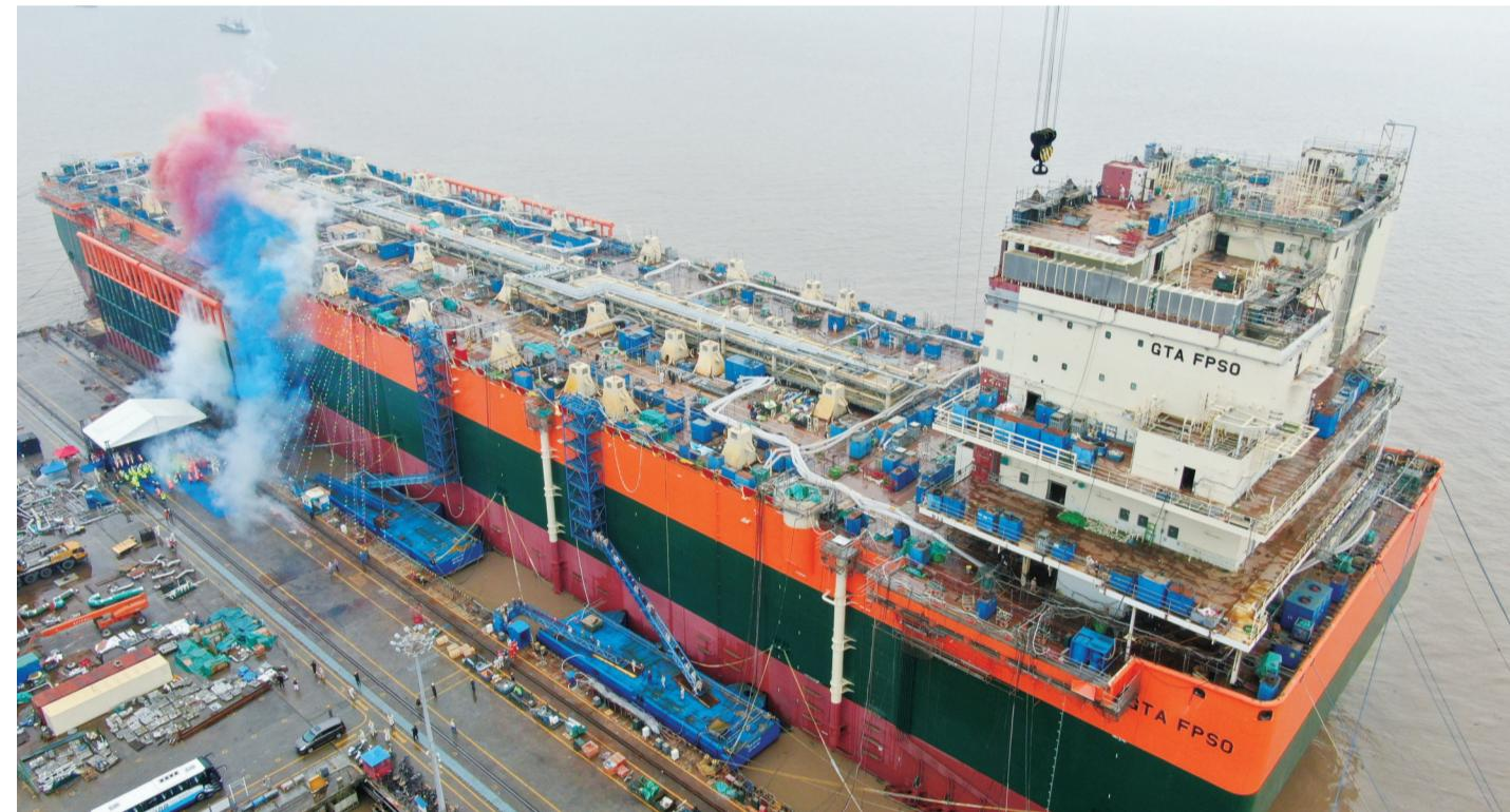
12日,由启东中远海运重工作业的浮式生产储卸油船N999 FPSO项目举行下水仪式。该船总重约20万吨,设计使用年限为30年,船长270米,储油量不少于144万桶,是中国船企首次为非洲项目建造的浮式生产储卸油船,集油气生产、处理、储卸、外输功能及系泊定位于一体,建造完成后将远赴非洲开展作业,为毛里塔尼亚、塞内加尔等国家提供天然气。
