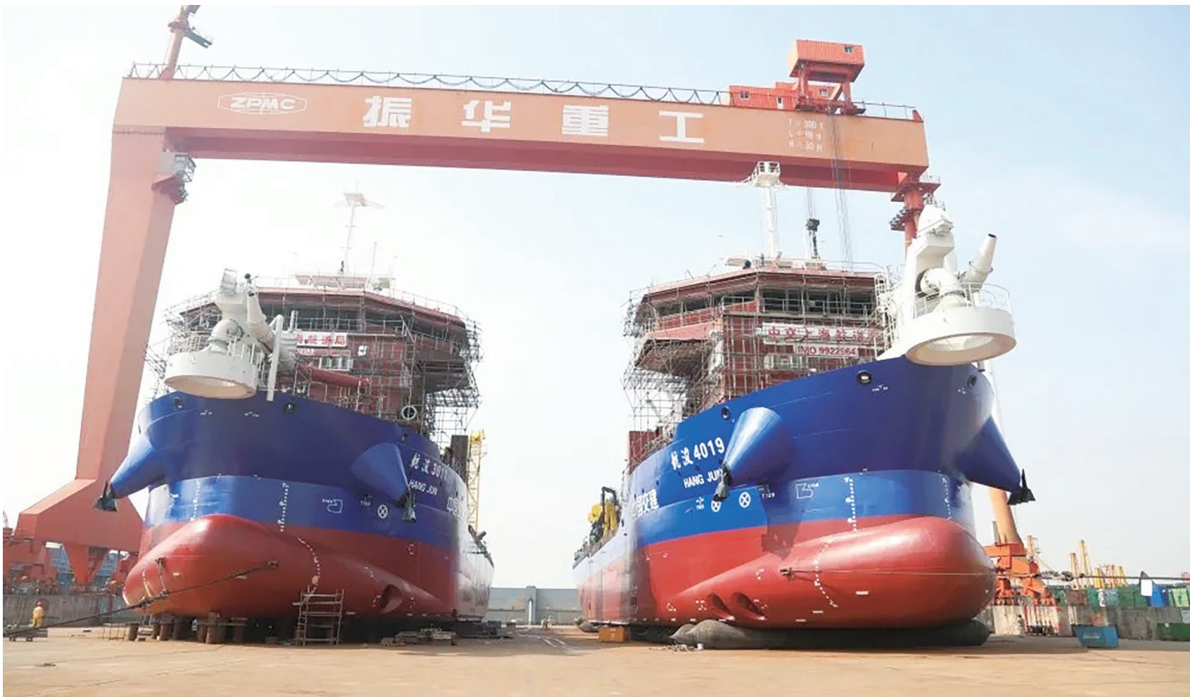
26日，由振华重工为上海航道局建造的两艘3000方等级耙吸挖泥船在振华启东海工顺利举行下水仪式。两艘3000方等级耙吸挖泥船为双机、双桨、复合驱动，船体为钢质流线型，舱容分别为3500立方米和4500立方米，上海航道局将用于港口航道疏浚工程。
