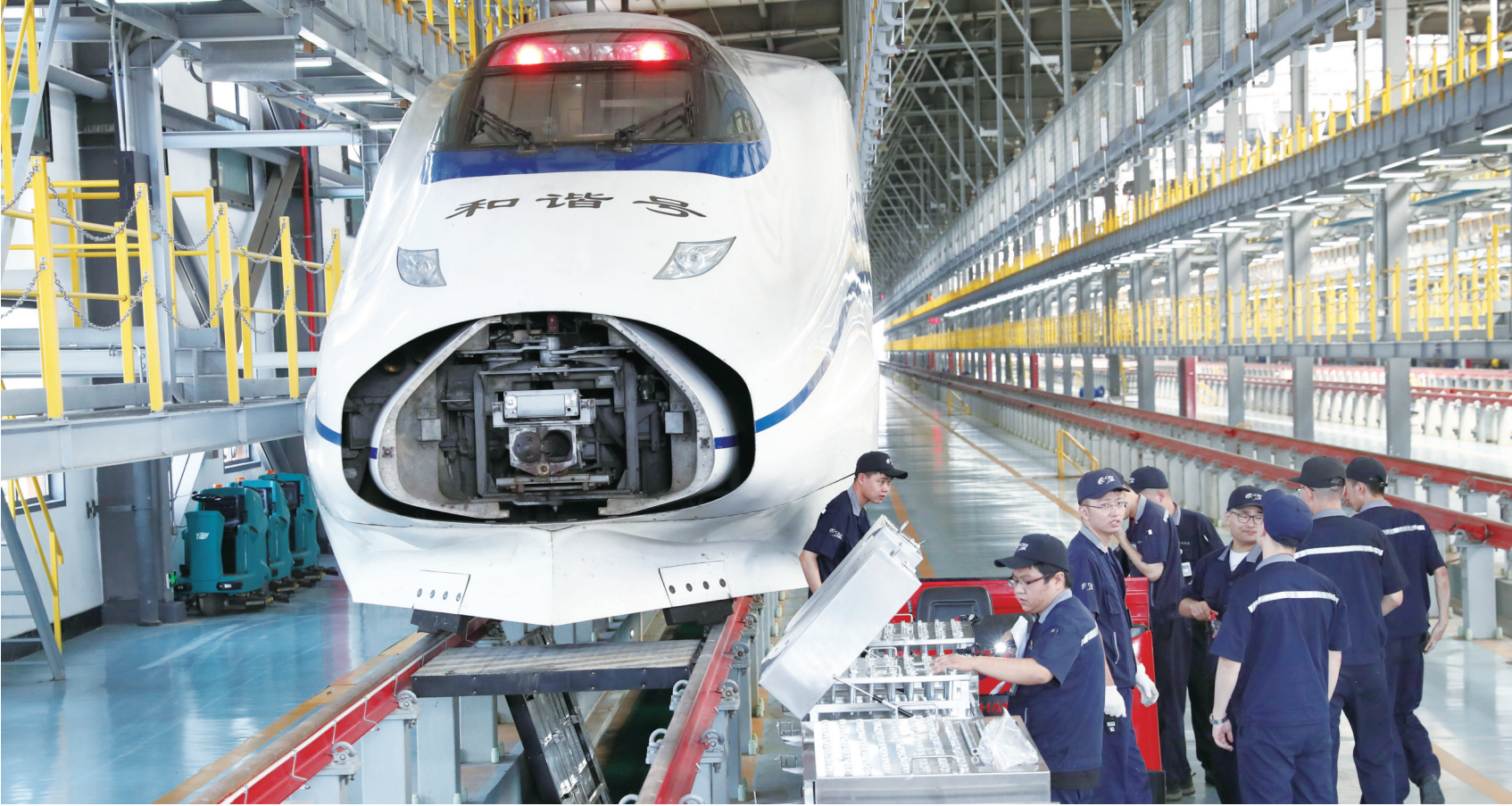
昨日，在崇川区幸福街道辖区的南通动车运用所检修库，地勤机械师在高温下进行动车组60万公里专项修。每组动车组60万公里专项修需12名机械师配合完成，共计25个项目需要耗时4天，这是南通动车运用所目前最复杂修理流程。 记者 许丛军摄
