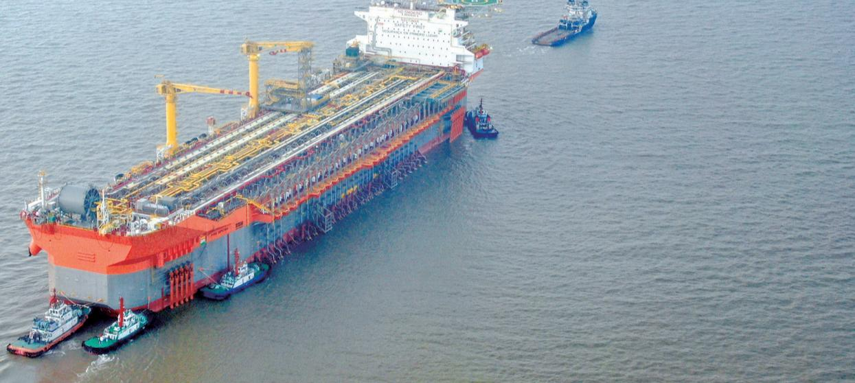
本报讯（记者吴霄云 通讯员滕永超 郭林）18日凌晨4时，在9艘大马力拖轮及“通常太”三地海事部门6条海巡艇的精心维护下，由招商局重工（江苏）有限公司建造的世界最大吨位、最大储油量FPSO（海上浮式生产储卸油船）“SEPETIBA”轮缓缓离开码头，开启拖带出江征程（上图 记者许丛军摄）。据悉，该船总长341.31米、总高85.5米、总宽86米、吃水6.8米，拖带船队总长度达634米，编队长度再次刷新长江通航历史之最。
