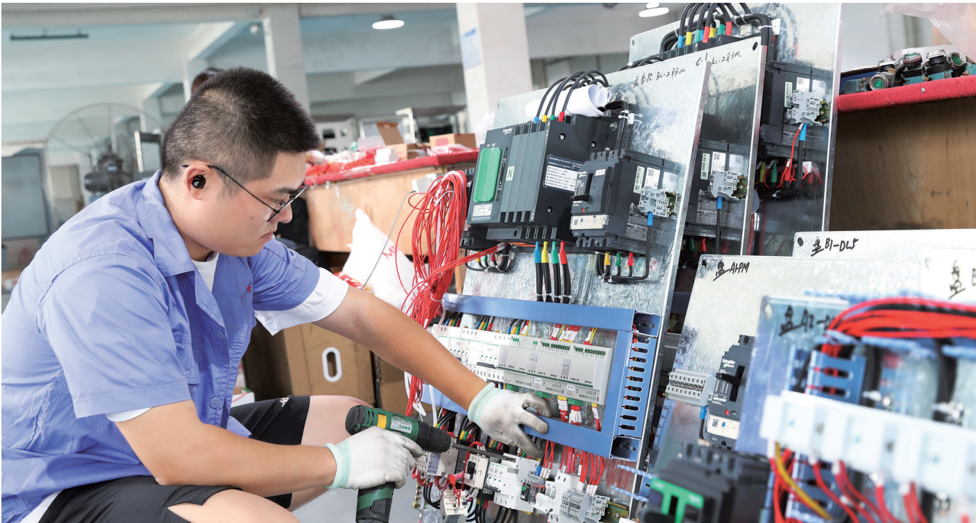
昨日,工作人员在电气车间装配南通地铁项目配电箱。位于如皋的南通中铁华宇电气有限公司正加紧生产用于南通市轨道交通 1 号线一期工程的照明配电箱、双电源切换箱等产品,预计共将交付照明配电箱 3500 多台。 中铁华宇公司是一家集 LED 照明工程设计、施工、产品研发、生产、销售服务于一体的系统解决方案供应商,典型的城市铁路案例包括合肥地铁 2 号线、3 号线,天津地铁 1 号线、4 号线,上海地铁 9 号线、13 号线等。 记者 许丛军摄
