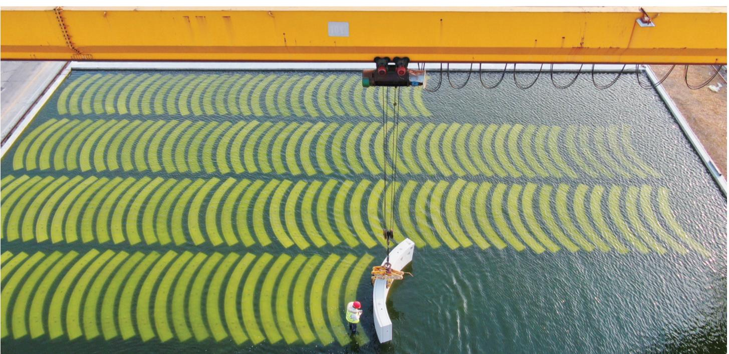
昨天，南通铁建建设构件有限公司工人在水养池吊运盾构管片。目前，该公司已为被称为“万里长江第一长隧”的长江盾构穿越工程“量身定制”国内单体最大、世界领先的盾构管片3115环，安装1993环。
