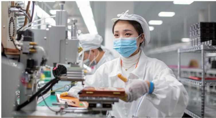
13日,位于海安高新区台商产业园的加百裕(南通)电子有限公司车间内,工人正在赶制供应国内外市场的锂电池产品。
