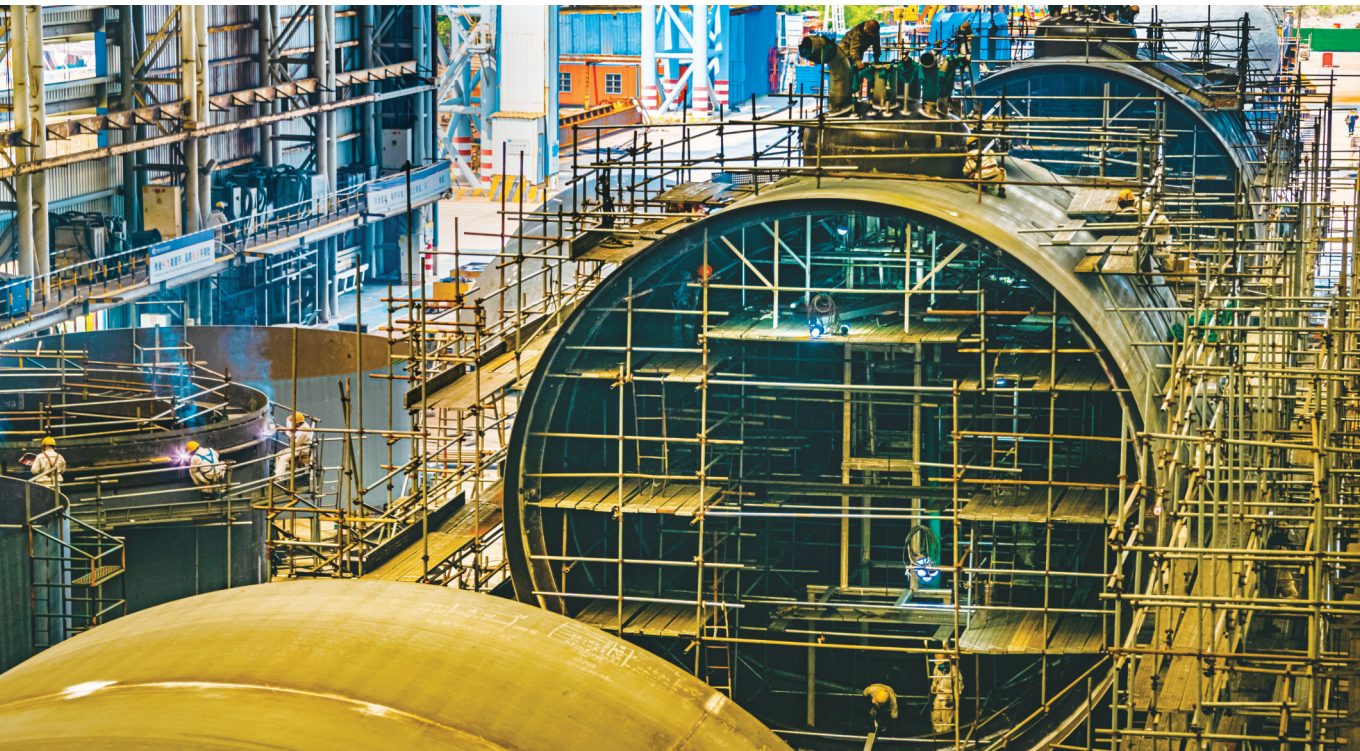
昨天，在南通中集太平洋海洋工程有限公司车间，工人正加紧制造C型液罐设备。 王海兵摄
