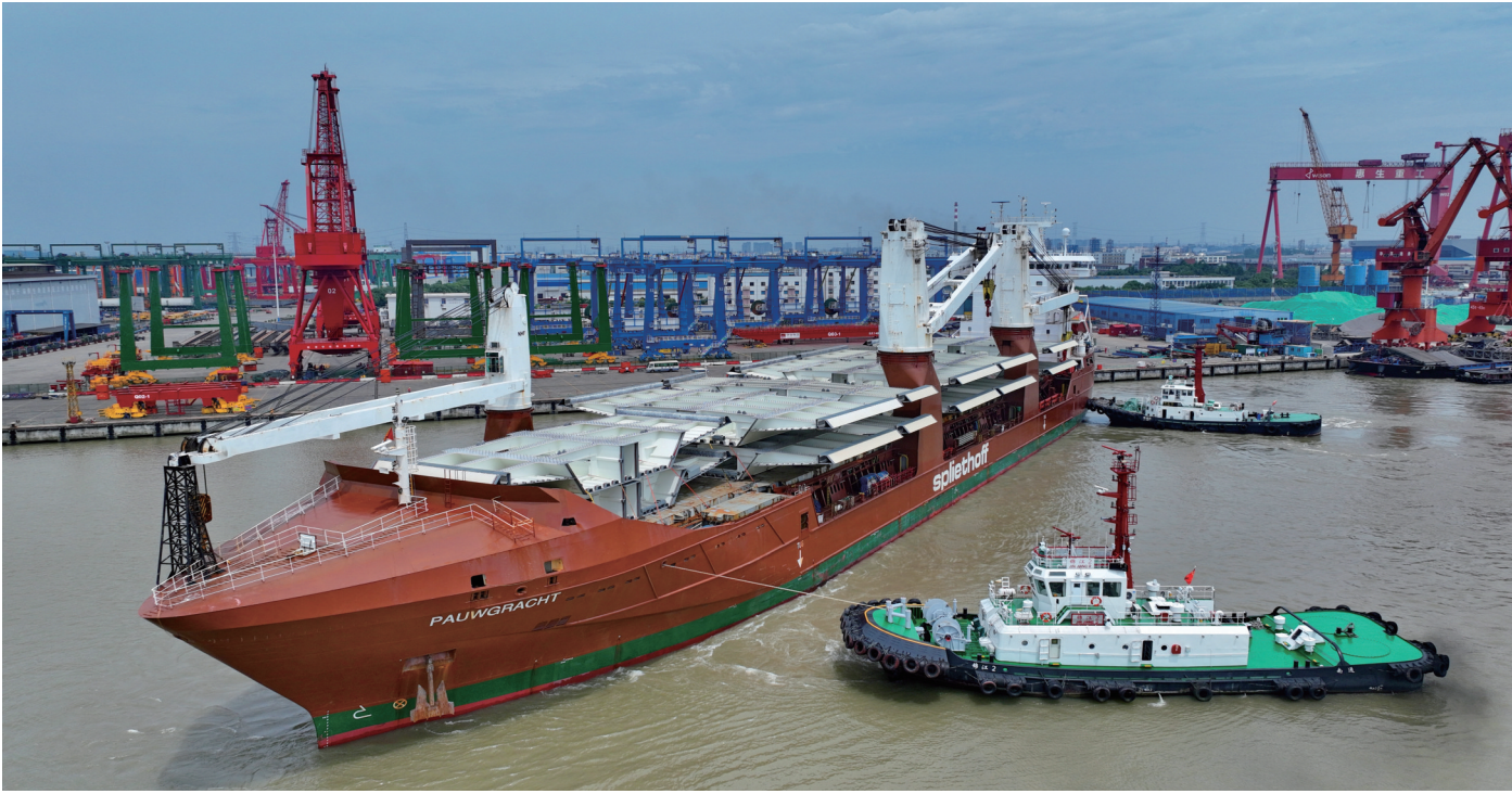
26日,在南通振华基地码头,中国企业承建的西非最大斜拉桥主桥所用钢箱梁段正式发运。本次发运的科特迪瓦科迪桥项目第二批次即最后一船次钢梁19个梁段,共计约2743吨。 记者 许丛军摄
