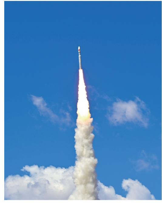
昨日 12 时 12 分，力箭一号运载火箭在我国酒泉卫星发射中心成功首飞，并顺利将 6 颗卫星送入预定轨道。力箭一号运载火箭是中国科学院自主研制的一型固体运载火箭，其搭载发射的 6 颗卫星用于开展空间探测、大气密度探测等相关技术验证及试验应用。
