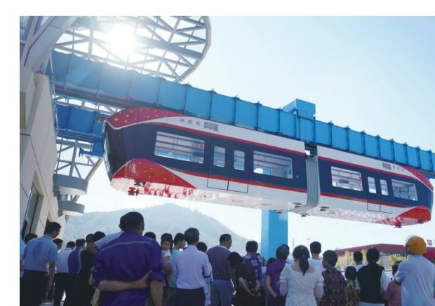
昨日,国内首条稀土永磁磁浮轨道交通试验线“红轨”,在江西兴国县正式竣工,并实现将稀土永磁磁浮技术与空轨技术结合,建成中低速、中低运量的新制式轨道交通系统。磁浮列车采用2车编组,载客能力为座席32个、定员88人,最高设计运行速度为80公里每小时。
