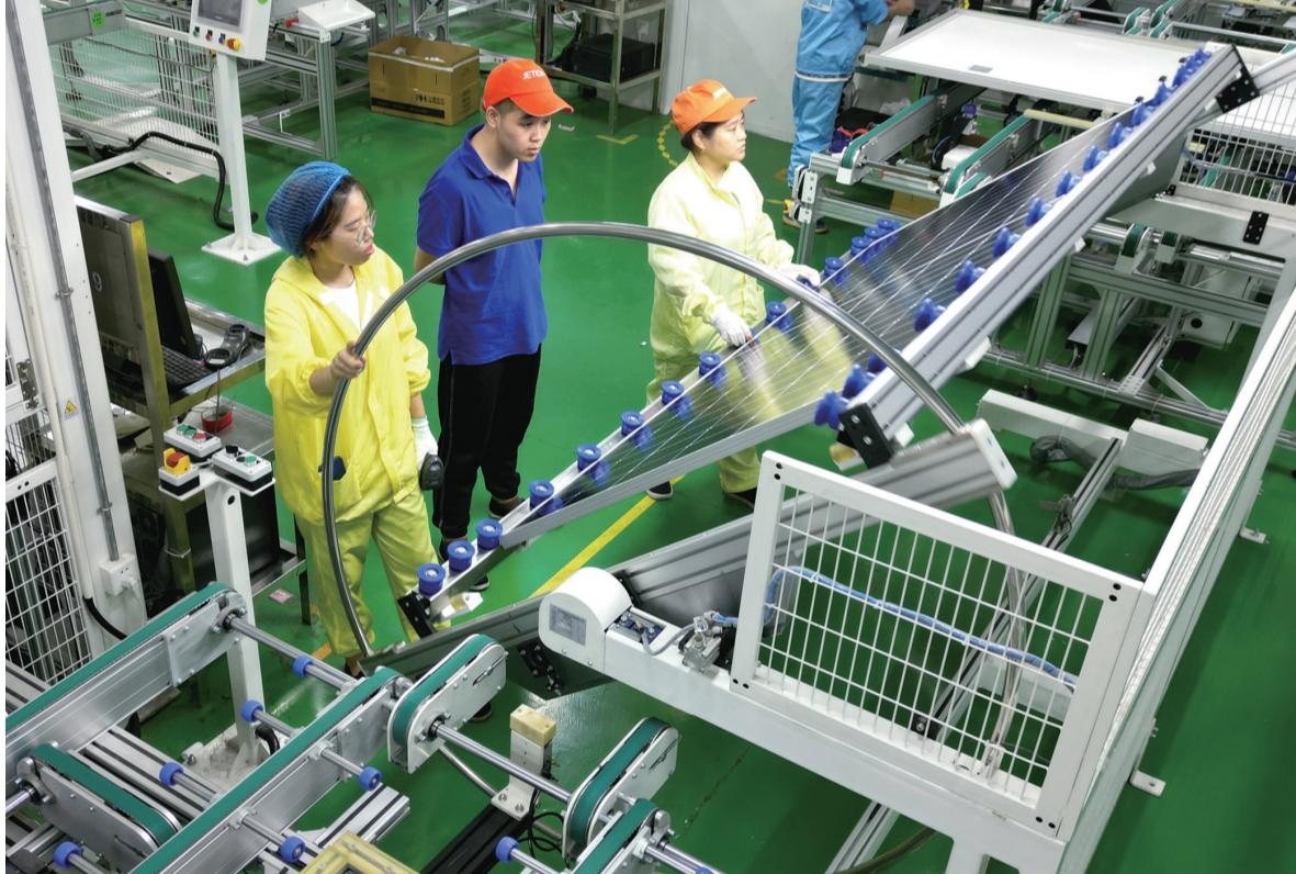
昨天,海安高新区的浚丰太阳能(江苏)有限公司智能车间内,全自动智能制造生产线高效运转。该生产线每天产出太阳能电池光伏组件6500件,与同等产能的传统生产线相比,用工减少约20%,能源消耗降低约30%,生产效率提升约160%。近年来,海安以科技创新为引擎,支持光伏企业加大科研创新投入,实施自动化、信息化、智能化等升级改造,延伸产业链、提升价值链、打造供应链,持续提高光伏产业竞争力。
