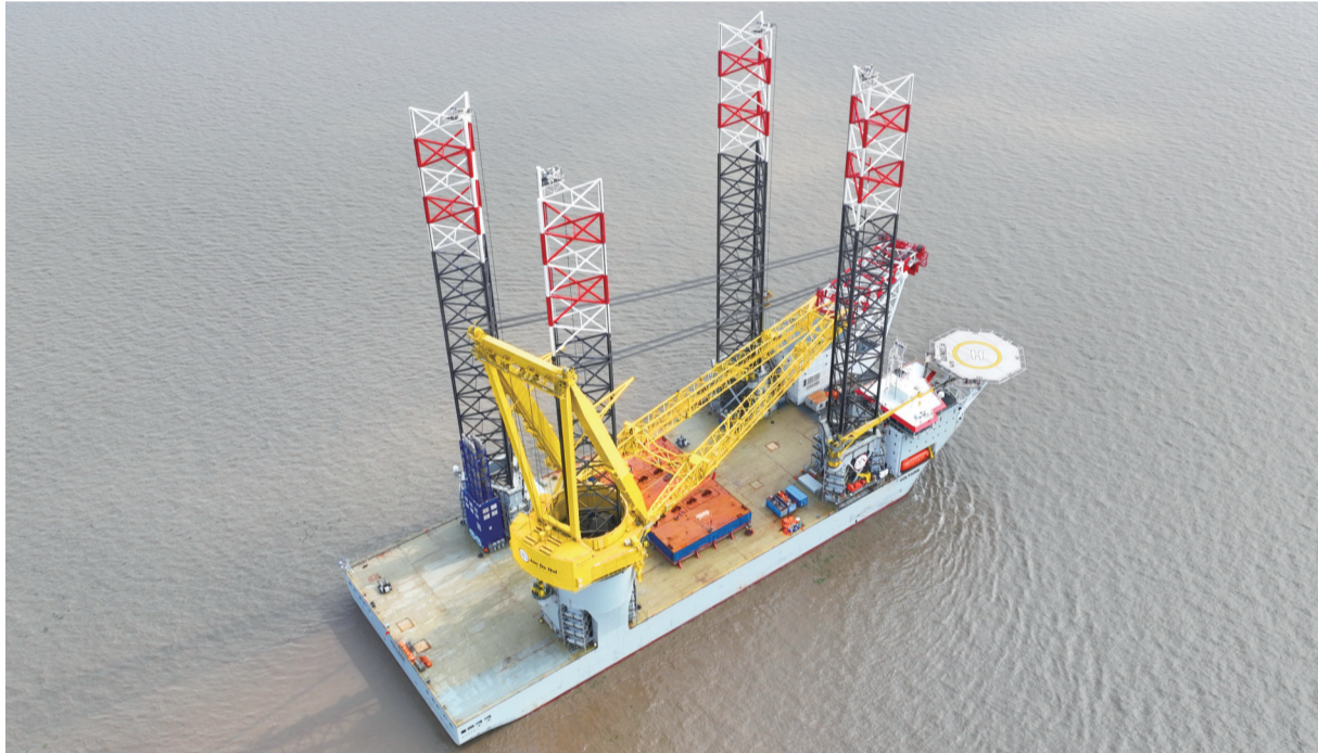
昨日，圆满完成出海试航的世界首艘3000吨级自升式风电安装船N966返回启东中远海运海工。在为期近一个月的出海试航过程中，该船顺利完成了航行系统试验、插桩、升降试验和主起重机的吊重等试验。近期交付后，将赴英国北海服务目前正在建的全球最大装机规模海上风电场。
