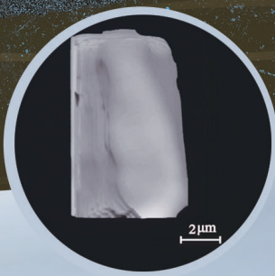
►“嫦娥石”真实颗粒CT扫描三维形态图。 新华社图片
