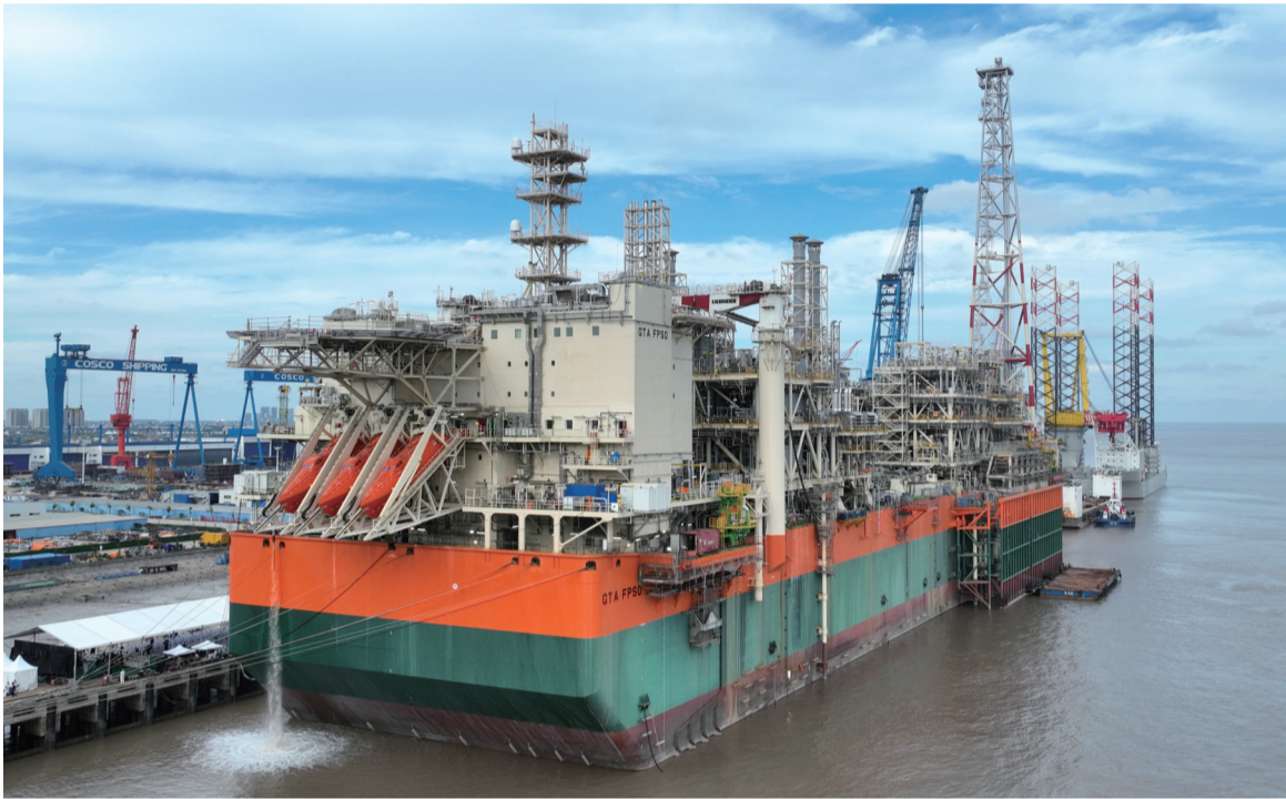
9日在启东中远海运海工拍摄的被誉为巨无霸“海上油气加工厂”的浮式生产储卸油船。当日，启东中远海运海工承建的世界最大天然气处理浮式生产储卸油船N999 Tortue FPSO宣布竣工。 N999 Tortue FPSO是中国船企首次为非洲天然气项目建造的浮式生产储卸油船，船长270米、型宽54米、型深31.5米。投入使用后，气体日处理量将达到5亿标准立方英尺。
