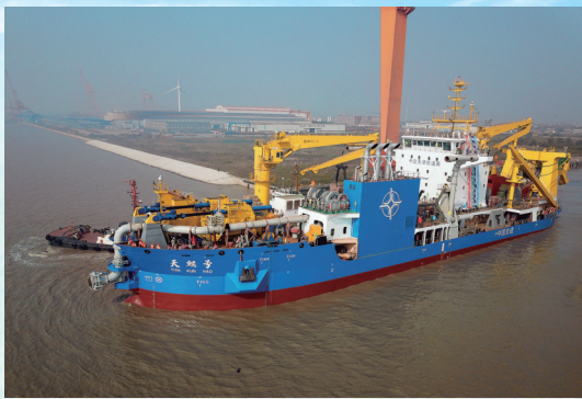
6600kW 绞刀功率自航绞吸式挖泥船
