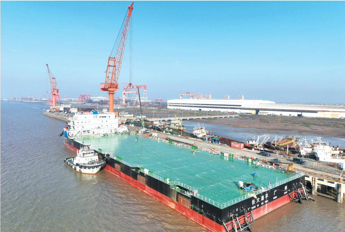
昨天,启东海工船舶工业园润邦海洋建造的“保利长大”多功能甲板驳等待交付。该船为非自航16000吨甲板运输驳,抗海上风浪强、载货面积大,主要用于海上风电、海上油气、跨海桥梁等超大构件和超重模块的装卸、运输及存储。
