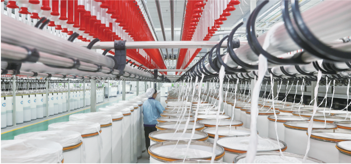
昨天,位于崇川区的大生智慧纺纱工厂车间内工人正在忙碌。江苏大生集团积极推进智能化改造和数字化转型,国内首个10万锭智慧纺纱工厂建成达产,工厂采用全流程智能化纺纱装备,万锭用工不到10人。许丛军摄
