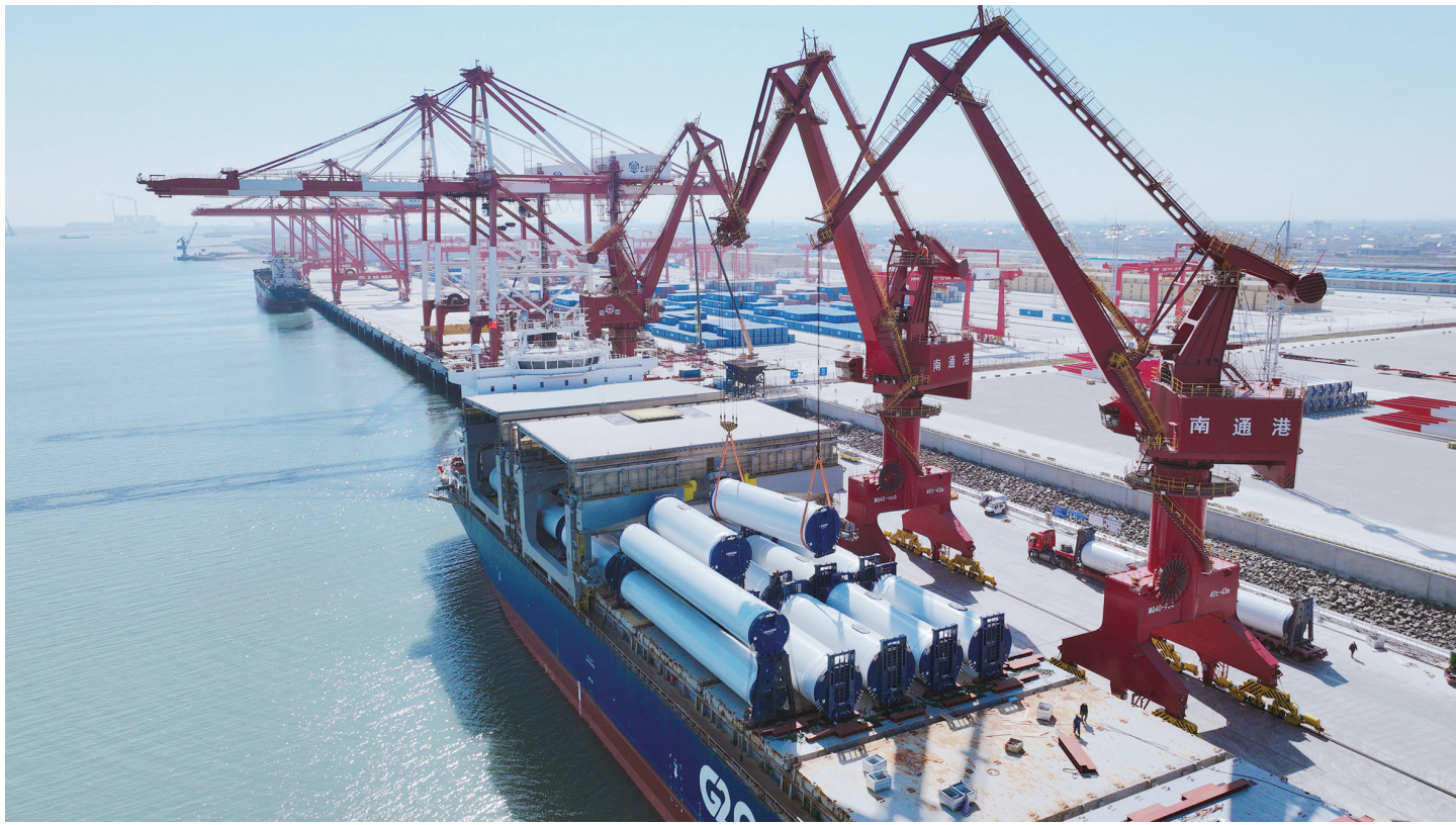
昨日 10 点 30 分，随着最后一件长 27.6 米、直径 3.373 米、重 48 吨的风电塔筒稳稳落在挪威籍杂货船“卡纷星”轮甲板上，吕四起步港区“2+2”码头通用泊位顺利完成开港以来首次国产风电塔筒出口装船作业任务，为打造长三角地区风电成套设备出口基地奠定坚实基础。 潘杨摄
