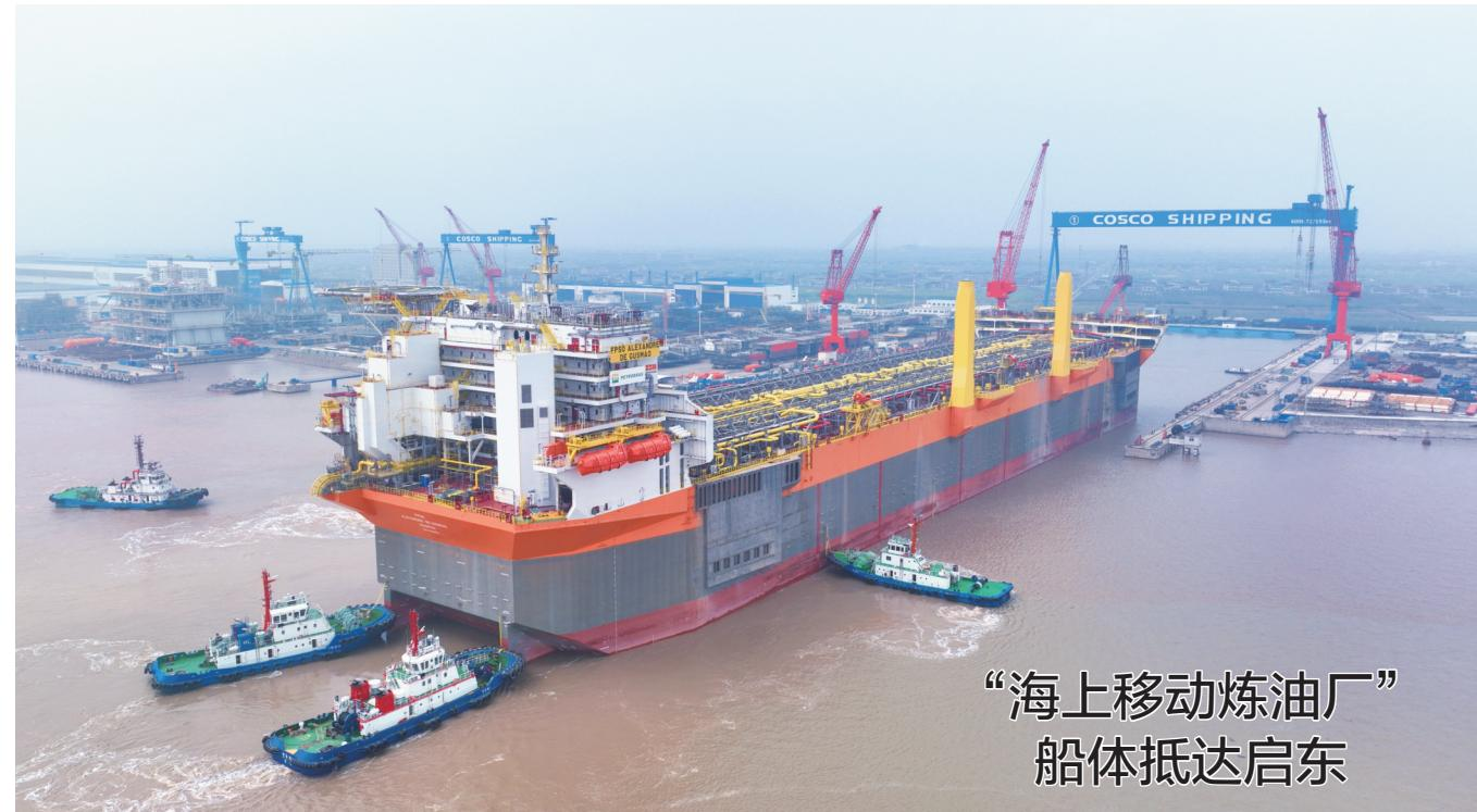
昨日13时许，在海巡艇及7艘大马力拖轮的全程维护下，M026 MER04 FPSO（海上浮式生产储油船）船体在启东中远海运工顺利完成进坞作业。据悉，该船体是目前世界最大吨位、最大储油量的新型海上浮式生产储油装置，是座名副其实的“海上移动炼油厂”。接下来，该FPSO船体将在启东中远海运工公司完成后续模块吊装包括模块建造、集成、调试、交付工作。潘杨摄
