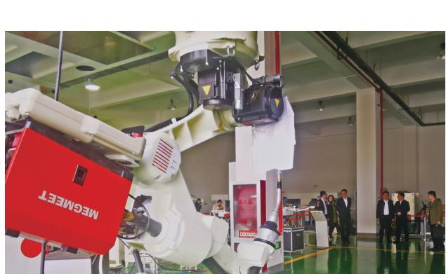
7日，访客在海安开发区华人华侨创新创业服务中心参观。该中心新研发成功的龙门焊接工作站项目样机，已经开始投放市场，广泛运用于海工装备、船舶和大型工件自动化焊接。
