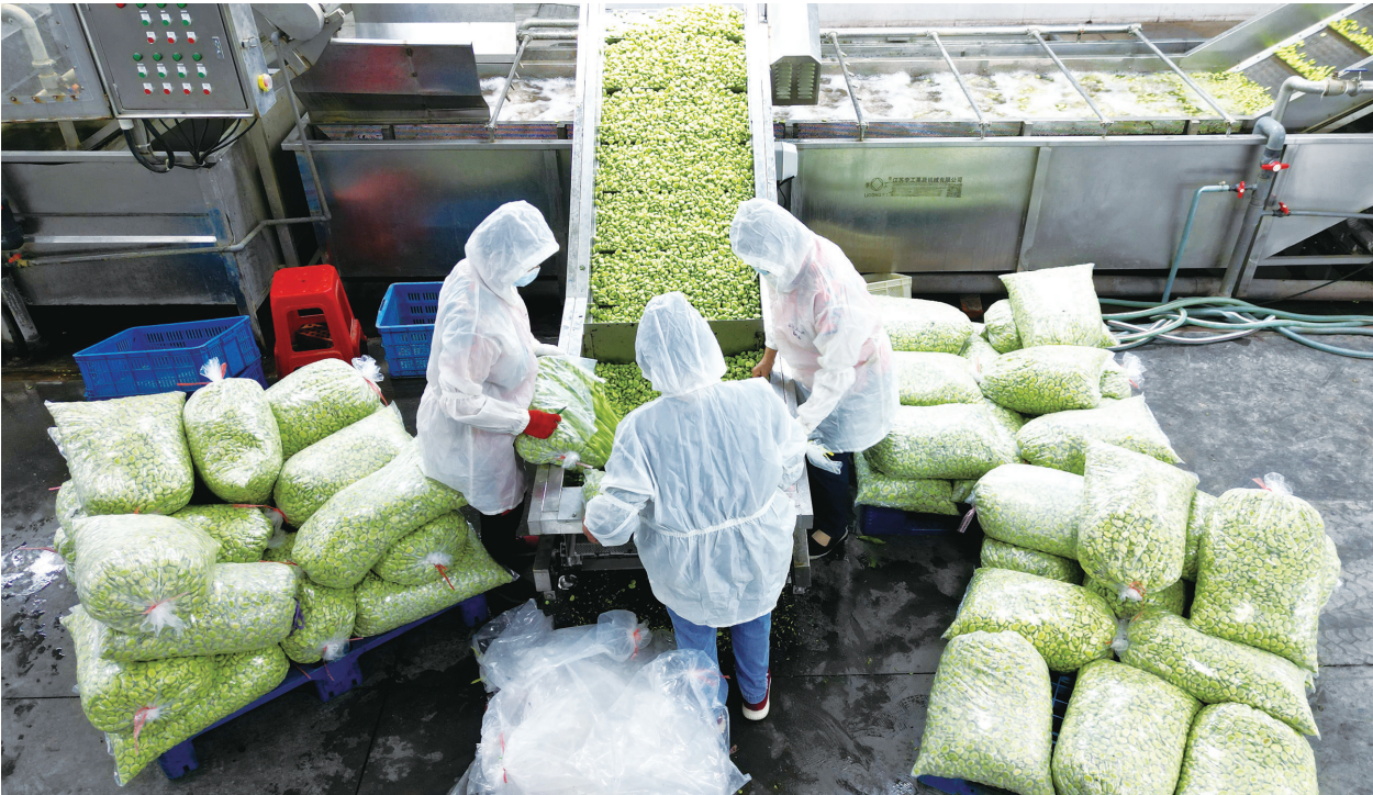
昨天,位于海安都市现代农业园的翠鲜园农业公司内,工作人员正在蚕豆速冻加工流水线忙碌,新鲜蚕豆经过筛选、清洗、漂烫、冷却、速冻、包装,将销往日本、西欧等国家及地区。近年来,当地农业产业化龙头企业以市场为导向,加工和储存豆类等冷冻鲜产品,促进特色蔬菜产业增效、农民增收。
