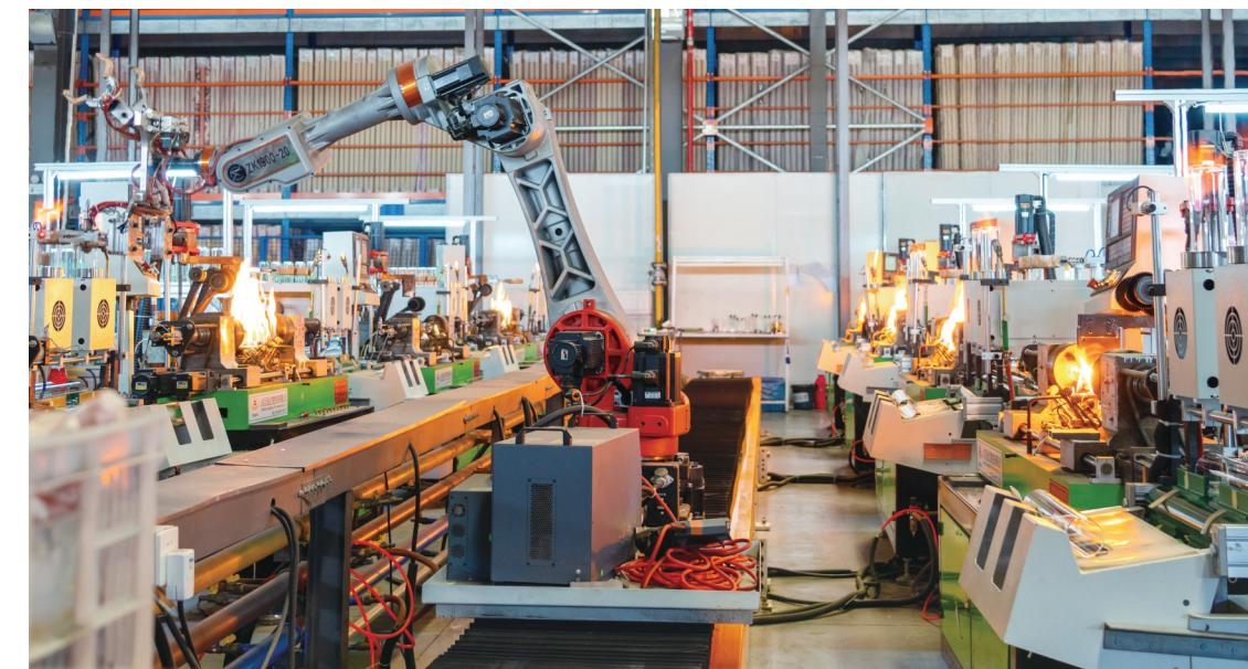
希诺公司玻璃车间厚底工序机械操作生产线。
