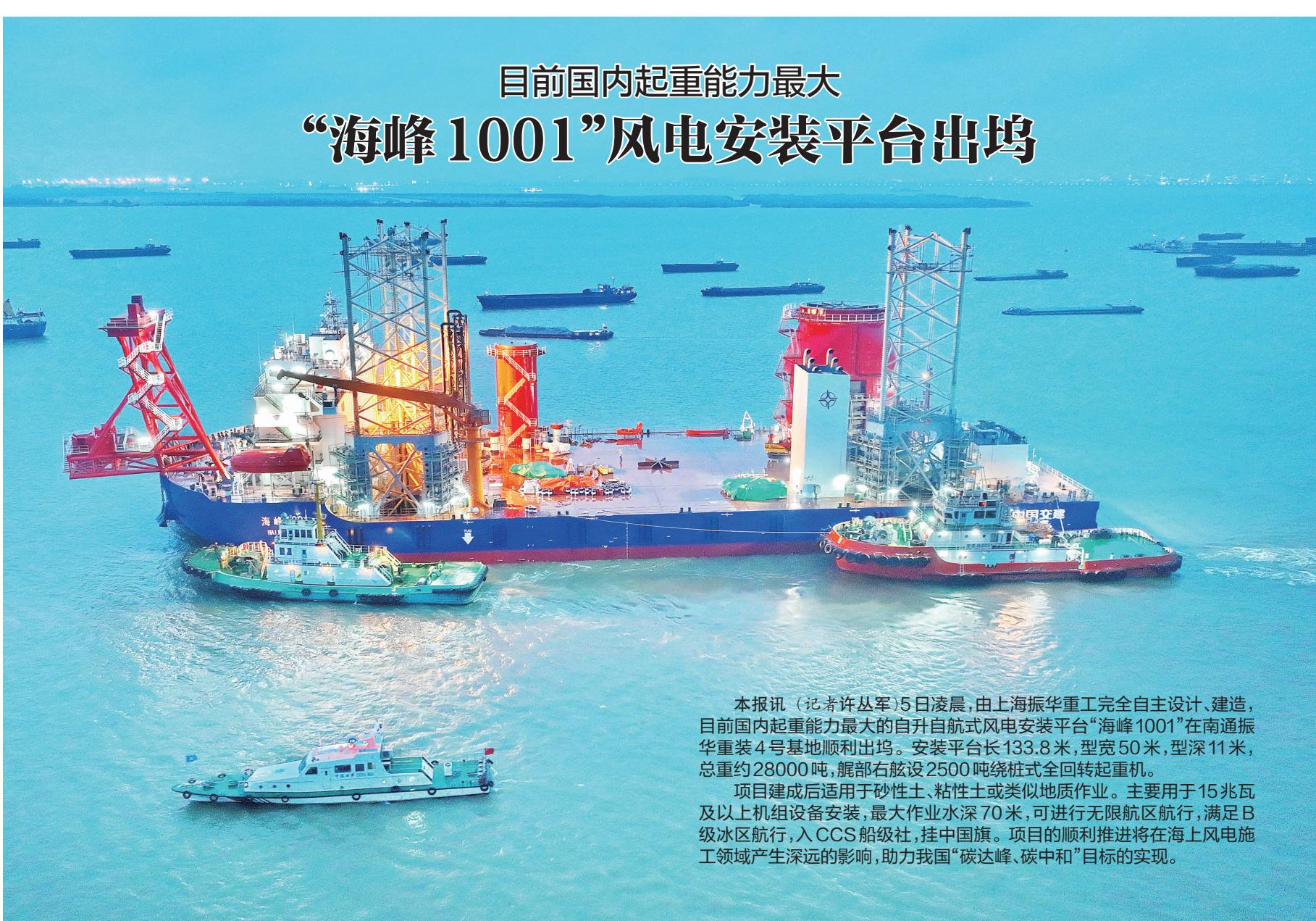
**本报讯**（记者许从军）5日凌晨，由上海振华重工完全自主设计、建造，目前国内起重能力最大的自升自航式风电安装平台“海峰1001”在南通振华重装4号基地顺利出坞。安装平台长133.8米，型宽50米，型深11米，总重约28000吨，艉部右舷设2500吨绕桩式全回转起重机。
