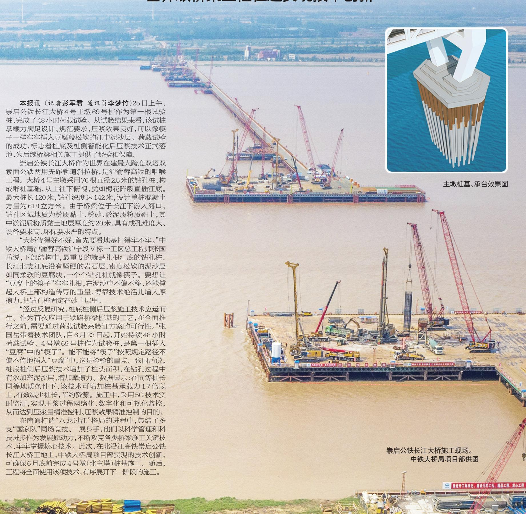
本报讯（记者彭军君 通讯员李梦竹）25日上午，崇启公铁长江大桥4号主墩69号桩作为第一根试验桩，完成了48小时荷载试验。从试验结果来看，该试验桩承载力满足设计、规范要求，压浆效果良好，可以像筷子一样牢牢插入豆腐般松软的江中泥沙层。荷载试验的成功，标志着桩底及桩侧智能化后压浆技术正式落地，为后续桥梁相关施工提供了经验和保障。
