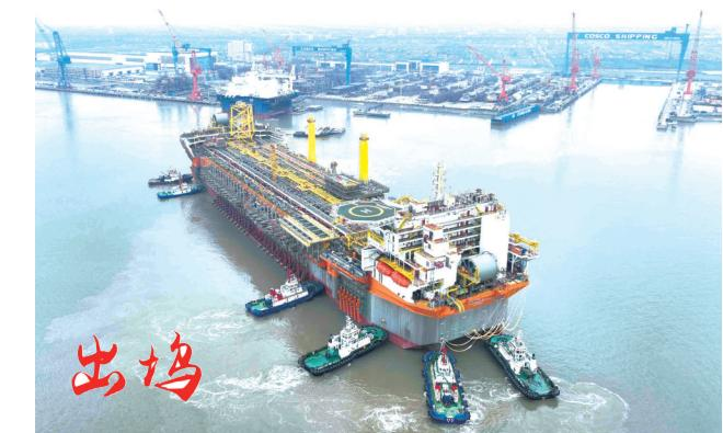
1日，世界最大吨位、最大储油量新型FPSO（海上浮式生产储油船）M026 MER04项目在启东中远海运海工顺利完成出坞作业。该FPSO项目采用独创的“通用型”Fast4Ward船体设计概念，设计日生产18万桶石油，可处理1200万标准立方米天然气，注水能力为每天25万桶。最大储存能力为140万桶原油，是座名副其实的“海上移动炼油厂”。
