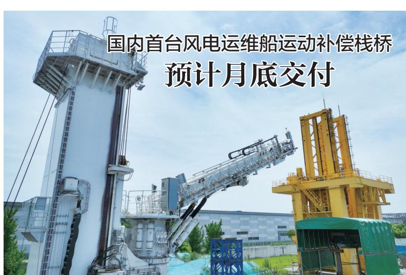
本报讯（记者许丛军）昨天，上海振华重工（南通）传动公司技术人员调试运动补偿栈桥波浪补偿系统，模仿海上风浪下反向补偿。据悉，国内首台风电运维船运动补偿栈桥预计月底交付，助力风电运维船服务于江苏、福建或广东海域的海上风电场。
