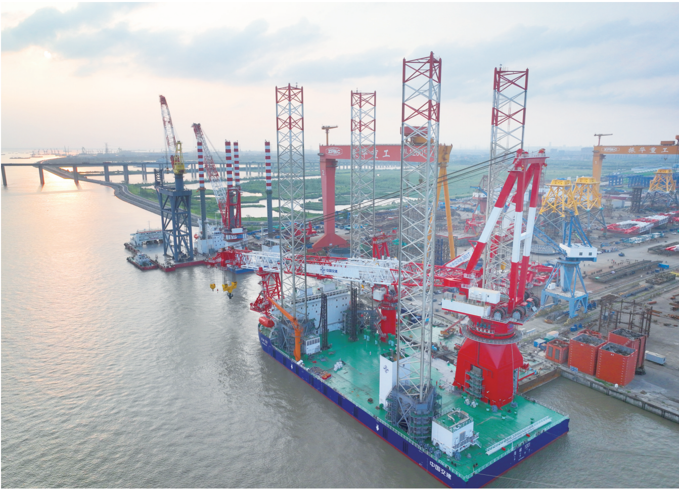
8日在振华南通重装码头拍摄的中交海峰2500吨自升自航式风电安装平台“海峰1001”。当日,中交海峰2500吨自升自航式风电安装平台“海峰1001”完成为期两天的全程抬升拔桩试验。该平台长133.8米,型宽50米,型深11米,总重约28000吨。
