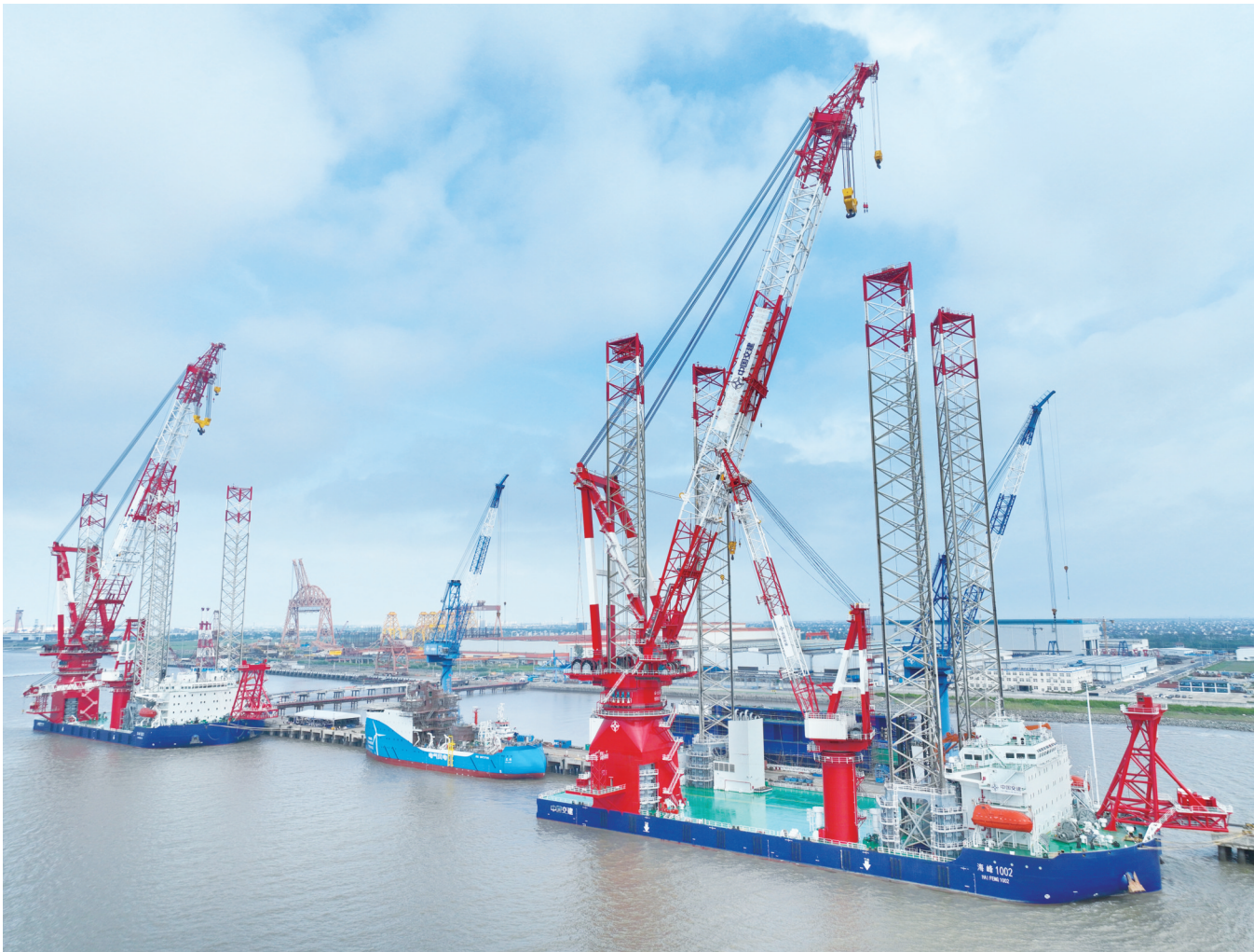
19日,新一代海上风电装备“海峰1001”“海峰1002”自航自升式风电安装平台在振华重工所属启东海洋工程正式交付。“海峰1001”“海峰1002”拥有多项国内之最。这两艘风电安装平台作业水深最大(70米)、吊高最高(主钩200米,副钩220米)、甲板面积最大(4500平方米)。
