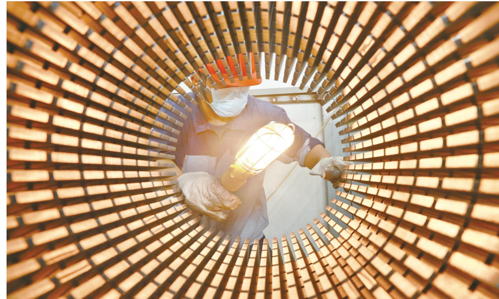
20日，工人在冲压车间进行定子铁芯整理。位于通州区兴仁镇的南通通达矽钢冲压科技有限公司，今年风力发电定转子铁芯接单3.54万吨，同比增长6%，生产繁忙。
